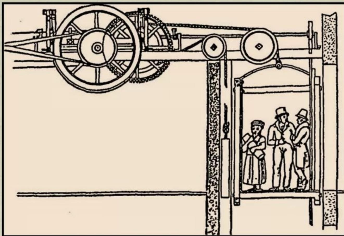
В 1793 Кулибин построил лифт, поднимавший кабинку при помощи винтовых механизмов.
